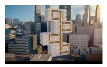
del mundo, que podrá desplazarse tanto vertical como horizontalmente a través de la utilización de motores lineales de corriente magnética; o ACCEL, un pasillo rodante que reduce hasta en un 66% los tiempos de tránsito y que puede trasladar hasta 7.300 pasajeros por hora y sentido, son los últimos desarrollos en sistemas de transporte de pasajeros de thyssenkrupp para afrontar los desafíos de la urbanización mundial.
